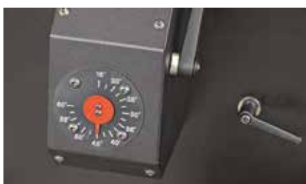
Ajuste preciso del ángulo del bisel
