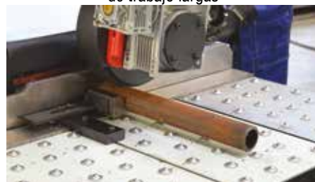
Posibilidad de biselado exterior de tubería
