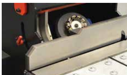
Fácil acceso al cabezal de corte y las plaquitas
