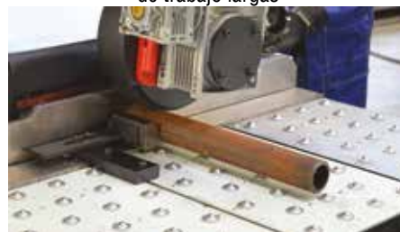
Posibilidad de biselado exterior de tubería
