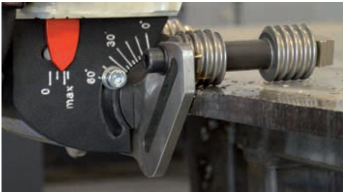
Ajuste continuo del ángulo de 0 a 60 grados
