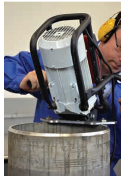
Biselado de tuberías
