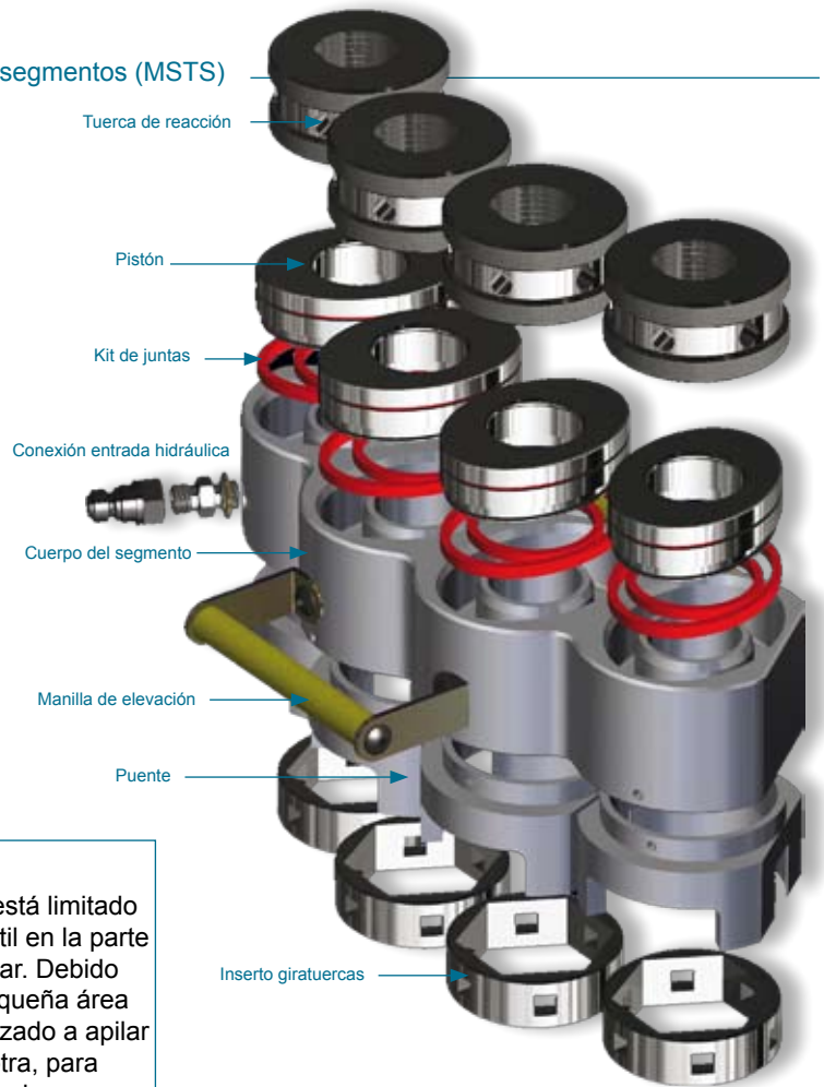
Vista de equipo de tensionado por segmentos estándar. Este modelo en particular está equipado con pistones elípticos
