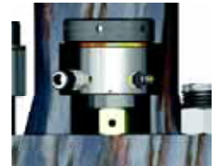
El tornillo está tensionado
