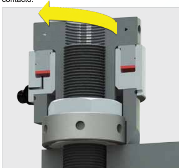
El inserto (puller) está roscado en el sobrante de perno por encima de la tuerca.
