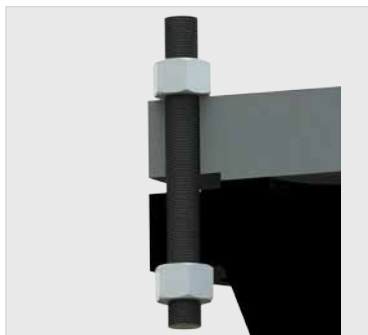
El perno y la tuerca están montados en la unión atornillada. Las caras de las bridas están en contacto.
