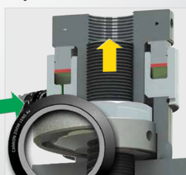
El tensionador está presurizado al valor precalculado. La carga en el perno es directamente proporcional a la presión hidráulica. El perno se estira y se crea una separación entre la cara inferior de la tuerca y la brida. Una vez se alcanza la presión deseada, esta se mantiene.
