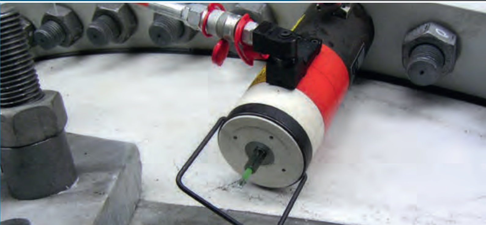
Versión de una etapa en condiciones de espacio restringidas en sentido axial
