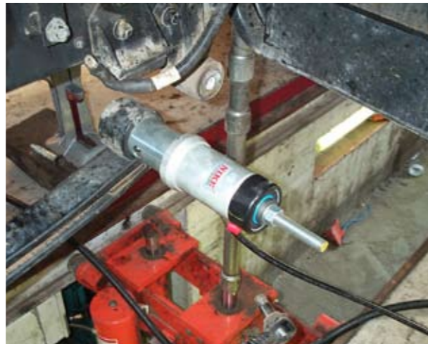
Extracción del viejo rodamiento en un camión DAF CF85 en Ford & Slater, Lincoln
